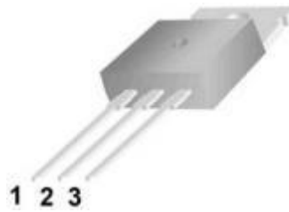
TO-220 1.Gate(G) 2.Drain(D) 3.Source(S)
